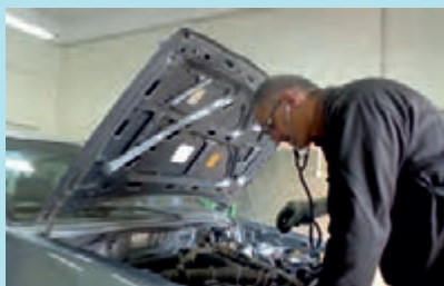
شکل ۱۹-۲- استفاده از گوشی مکانیکی
