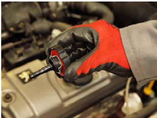
۴ از روی شاخص سطح روی بدنه یا در مخزن، سطح مایع موجود در مخزن بررسی شود. در صورت کم بودن سطح مایع به مرحله نشتی‌یابی مراجعه و پس از نشتی‌یابی به مرحله سرریز مراجعه شود.
