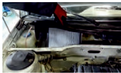
شکل ۲۹-۳ روش عوض کردن فیلتر هوای اتاق خودرو
