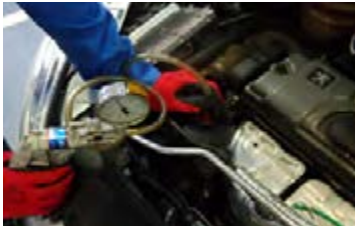
۶ پمپ دوباره روی مخزن بسته شود.
