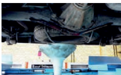
۲ پیچ تخلیه روغن دیفرانسیل باز شود.
