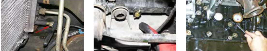
شکل ۷-۲۸- انواع پیچ تخلیه مایع خنک کننده موتور
