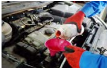
۸ پس از جداکردن پمپ، سطح مایع مخزن بررسی شده و در صورت لزوم به آن اضافه شود.
