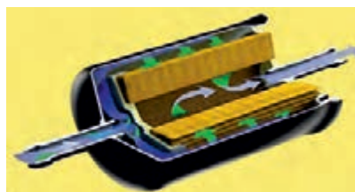
شکل ۳۱-۳- ساختمان فیلتر بنزین
