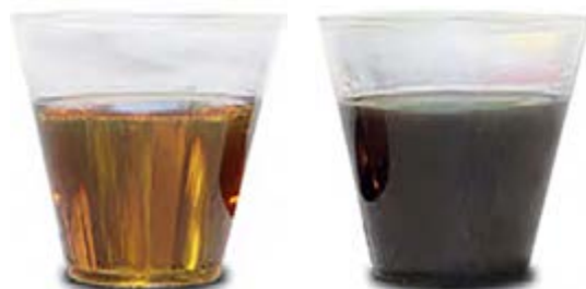
شکل ۴-۶- تفاوت رنگ مایع هیدرولیک ترمز نو و کارکرده
