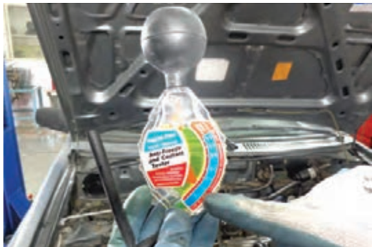
شکل ۷-۸- روش استفاده از هیدرومتر
