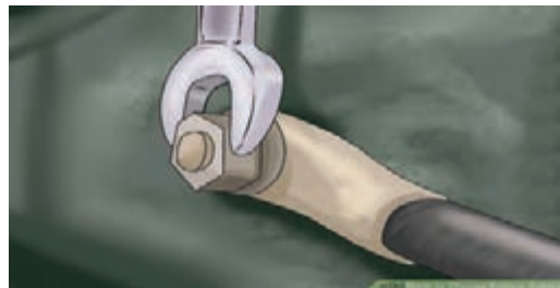
شکل ۱۱-۹- اتصال منفی یا اتصال بدنه قسمت موتور
