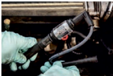
شکل ۸-۱۶- دستگاه آزمایش جرقه
