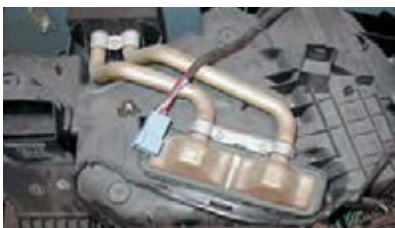
۶ شیلنگ‌های رابط و بست‌های بخاری بررسی شود.
