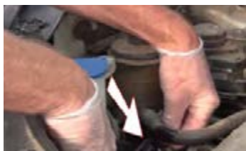
۶ هم‌زمان با تخلیه مایع کار کرده، مایع تازه به مخزن اضافه شود.
