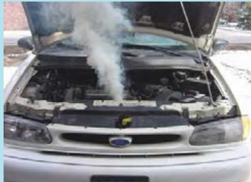
شکل ۱۷-۷- پاشش آب رادیاتور
