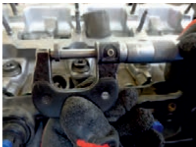
۴ شیم هر سوپاپ اندازه‌گیری شود.
