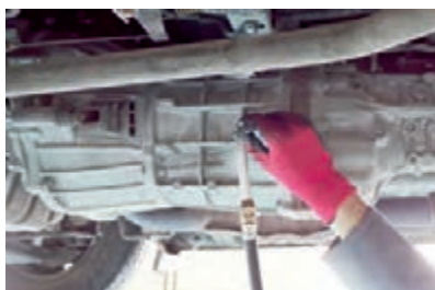
۲ روغن با پمپ دستی، برقی یا بادی پر شود و پیچ ورودی بسته شود.
