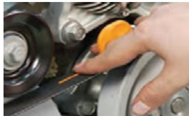
شکل ۱۴-۲- گوشه مکانیکی (استاتسکوپ) و ابزار بررسی فاصله تسمه و شیار پولی
