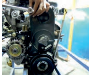
۲ تسمه تجهیزات جانبی باز شود.
