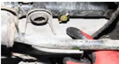
شکل ۷-۲۹- تخلیه مایع خنک کننده موتور به روش دستی
