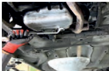
۵ پیچ تخلیه روغن موتور را باز کنید. (برای تخلیه بهتر و سریع تر روغن، در ورودی روغن موتور (درپوش سرسیلندر) باز باشد).
