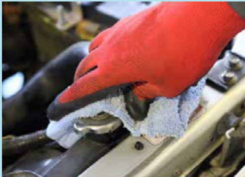
شکل ۱۷-۷- پاشش آب رادیاتور
