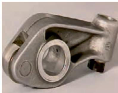
شکل ۳۲-۸- دو نوع تنظیم‌کننده هیدرولیکی سوپاپ‌ها
