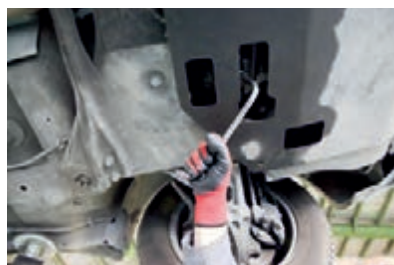
۱ پیچ تخلیه روغن بسته شود.
