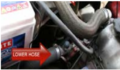
۲ لوله‌های (شیلنگ) رادیاتور بررسی شود.
