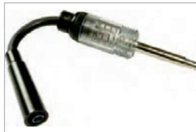
شکل ۸-۱۶- دستگاه آزمایش جرقه
