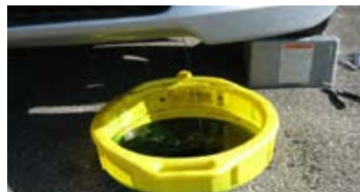
شکل ۷-۲۹- تخلیه مایع خنک کننده موتور به روش دستی
