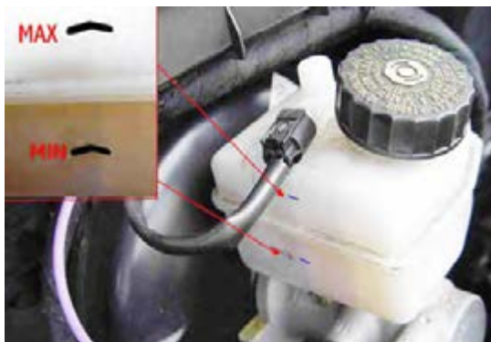
شکل ۵-۶- بررسی سطح مایع هیدرولیک ترمز
