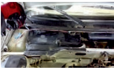
شکل ۲۹-۳ روش عوض کردن فیلتر هوای اتاق خودرو
