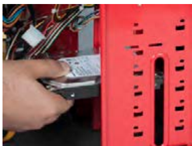
شکل ۴۸- محل نصب دیسک سخت
