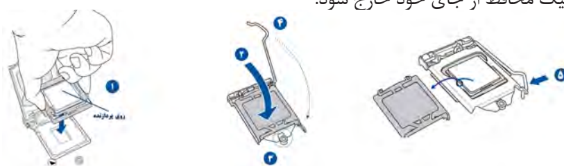
شکل ۳۵- مراحل قراردادن پردازنده در سوکت
