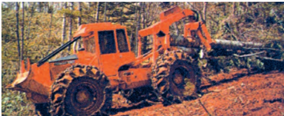
شکل ۲۱-۲ الف - گرده‌بینه‌ها به وسیله تراکتورهای چوب‌کش از جنگل خارج می‌شوند (چرخ‌ها برای جلوگیری از سر خوردن به زنجیر مجهز می‌شوند).
