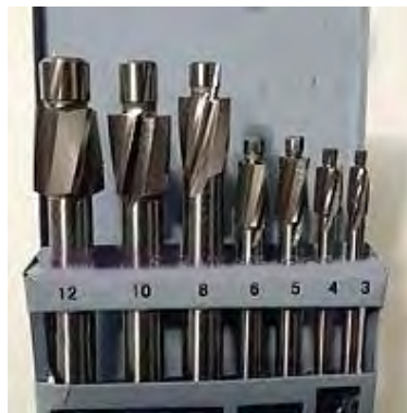
شکل ۴-۲۹- انواع مت‌ه خزینه‌ای استوانه‌ای دنباله‌دار
