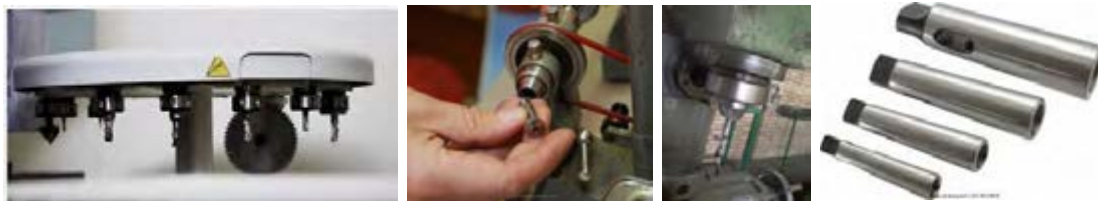
شکل ۴-۲- کاربرد سوراخ مخروطی در دستگاه‌های فرز
