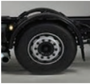
شکل ۳- موقعیت نصب گلگیر و باران گیر
