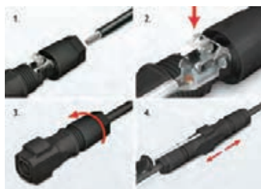
شکل ۴۵- مراحل اتصال کانکتور MC4
