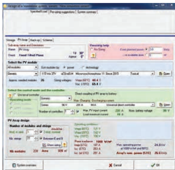
شکل ۳۸ - مقادیر مدول PV، کنترل شارژ
