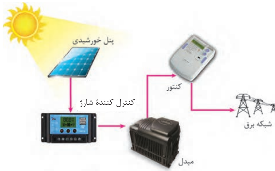
شکل ۵۱- نقشه ارتباط عناصر سیستم فتوولتائیک On_Grid
