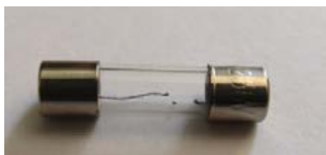
شکل ۱۶ - فیوز آسیب دیده است.
