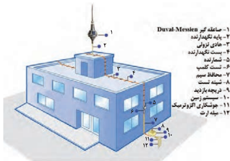
شکل ۴۱- تجهیزات صاعقه گیر
