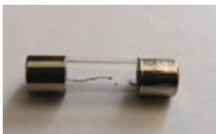
شکل ۴۹- فیوز سر راه باتری سوخته است.
