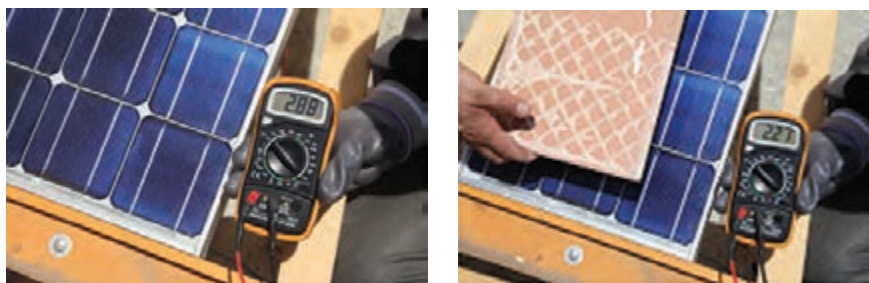
شکل ۷- ب - اثر سایه بر جریان اتصال کوتاه
