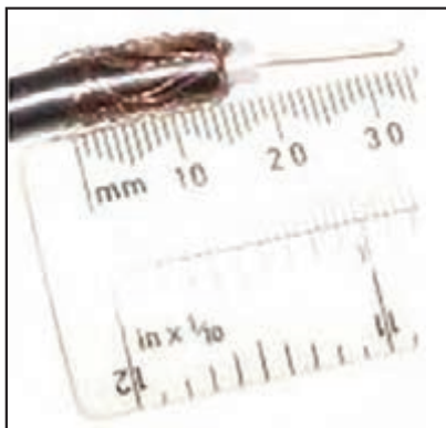
۴- عایق زیر را نیز روکش برداری کنید.
