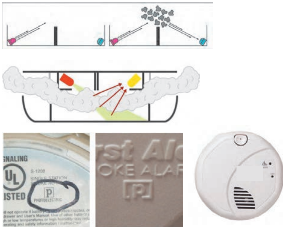
شکل ۳۲ - عملکرد دتکتور دودی و علامت مشخصه آن
