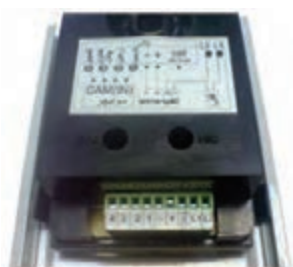
شکل ۲۵- محل تنظیم صدای بلندگو و میکروفون
