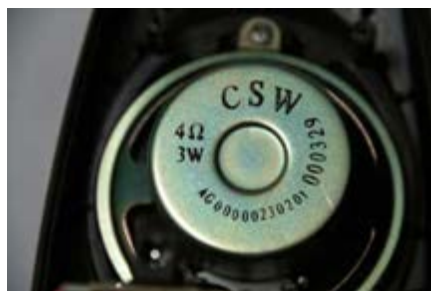
شکل ۹- توان بلندگو و امپدانس
