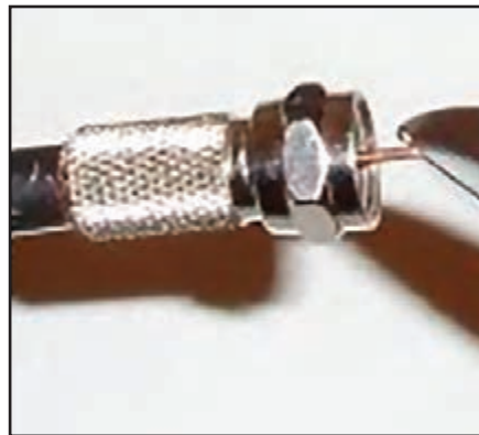
۷- قسمت اضافه مفتول مسی را قطع کنید.
