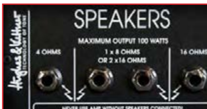
شکل ۲۰- امپدانس خروجی بلندگو
