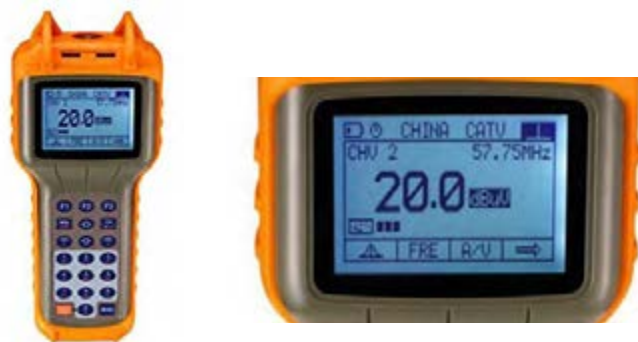
شکل ۲۴- اندازه‌گیری سیگنال خروجی آنتن توسط سیگنال سنج
