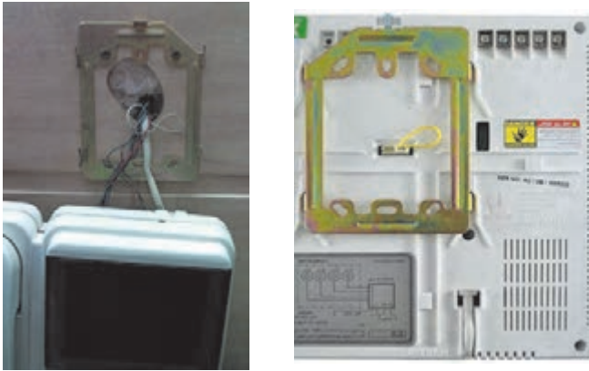
شکل ۱۱- پایه و نحوه نصب آن صفحه نمایش در بازکن
