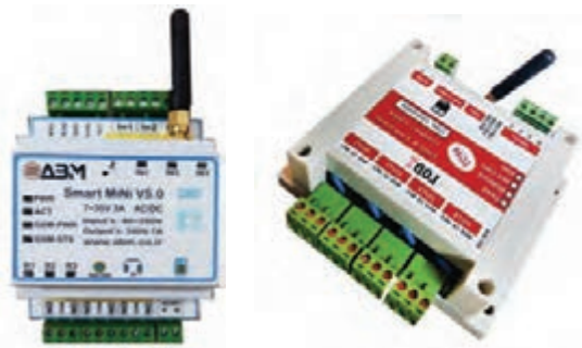
۱۶- سامانه کنترل از راه دور با پیامک
