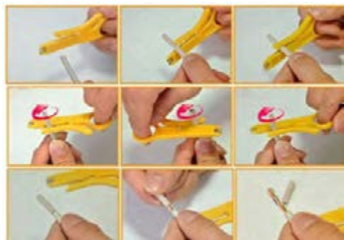
شکل ۷ - روکش برداری کابل
