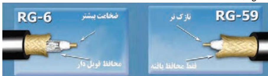
شکل ۴- مقایسه دو نوع کابل RG
