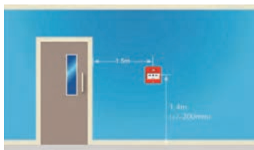
شکل ۲۱- محل و ارتفاع نصب شستی
