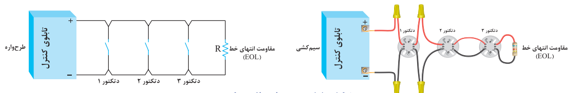
شکل ۵۵- نحوه اتصال دکتور
