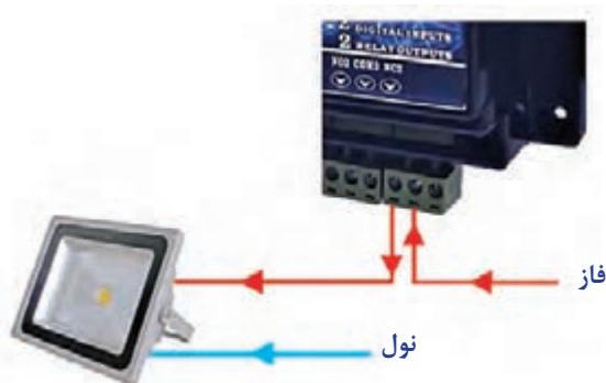
شکل ۲۰- نحوه کنترل دستگاه برقی
