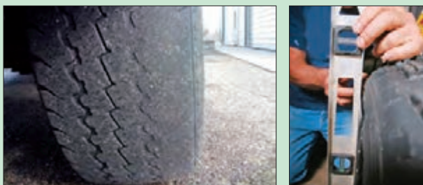
شکل ۴۱- تأثیر تنظیم نبودن زوایای چرخ جلو
