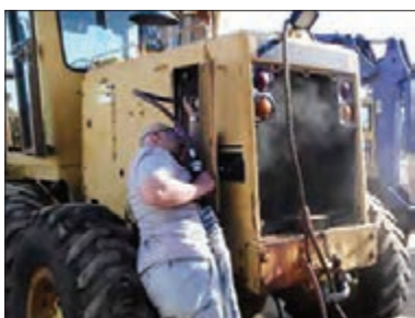
شکل ۲۷-۳ تمیز کردن رادیاتور
