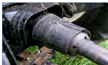
شکل ۳۳-۱- گاردان مجهز به کلاچ یک‌طرفه
