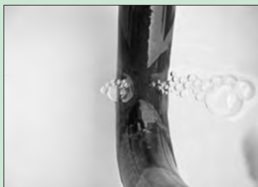
شکل ۷۵-۴- تشخیص پنچری تیوب
