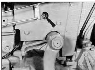
شکل ۳۷-۴- بازدید سطح روغن جعبه فرمان تراکتور ۲۸۵
