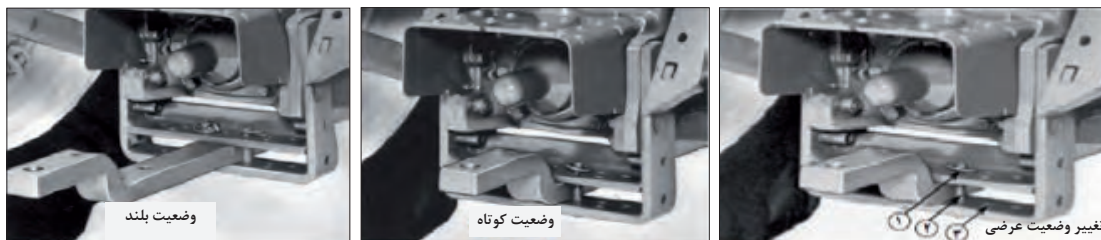
شکل ۴۳-۱ تنظیمات مالبند قابل تنظیم
