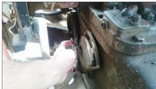
شکل ۲۶-۴- گیج روغن هیدرولیک تراکتور فرگوسن ۲۸۵
