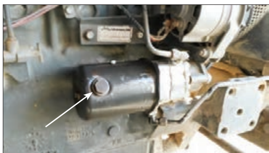
شکل ۳۸-۴- محل بازدید روغن پمپ فرمان تراکتور فرگوسن ۲۸۵
