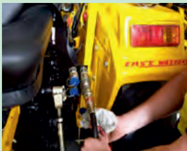
شکل ۲۵-۱- تمیز کردن سرشیلنگی و اطراف خروجی هیدرولیک تراکتور
