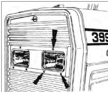
شکل ۱۶-۴- پیچ های تنظیم چراغ
