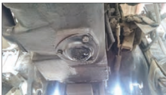
شکل ۳۰-۴- درپوش تخلیه روغن هیدرولیک تراکتور MF ۲۸۵
