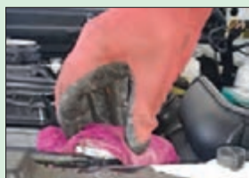
شکل ۲۹-۳ باز کردن درب رادیاتور
