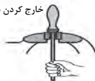
شکل ۳۶-۵ جاذدن و خارج کردن دسته سوهان
