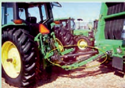
شکل ۴۵-۱ اتصال شیلنگ‌های هیدرولیک (الف) (ب)
