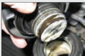
شکل ۱۱-۱- بازدید آب رادیاتور
