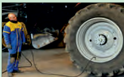
شکل ۷۸-۴- فاصله مناسب را در هنگام باد کردن تایر رعایت کنید.
