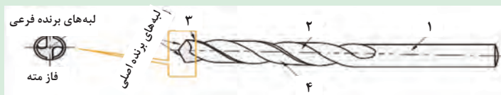
شکل ۴۰-۵- اجزای مته مارپیچی
