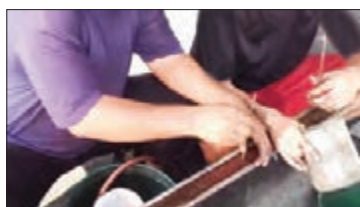
شکل ۲۸-۳ سیخ زدن رادیاتور
