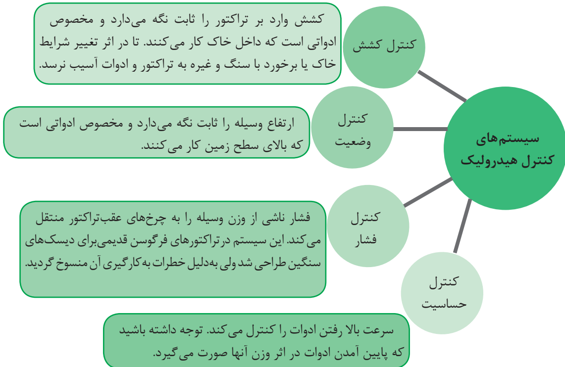
نمودار ۱-۱- انواع سیستم‌های کنترل هیدرولیک تراکتور
