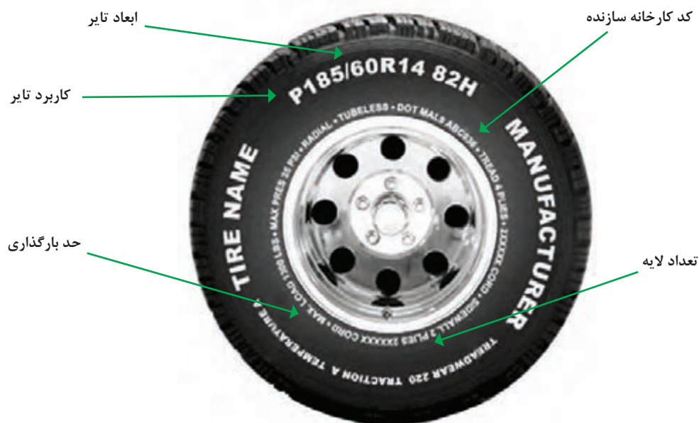
شکل ۴۰- مشخصات فنی و ظاهری تایر
