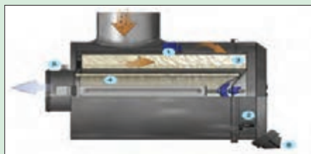
شکل ۹-۳- مسیر عبور هوا در صافی روغنی
