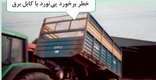
شکل ۶۳-۱- ارتفاع پی نورد را در هنگام تخلیه در نظر بگیرید.
