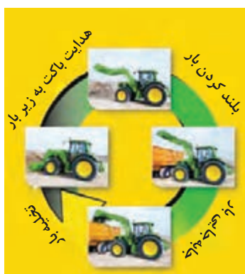
شکل ۱-۷۴- مراحل باربرداری با بیل
