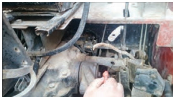
شکل ۲۷-۴- گیج روغن هیدرولیک تراکتور فرگوسن ۳۹۹
