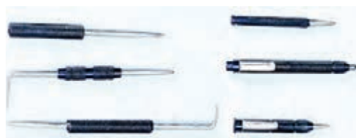
شکل ۱۹-۵- انواع سوزن خط‌کشی
