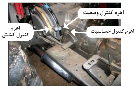
شکل ۱۹-۱- اهرم های کنترل هیدرولیک تراکتور فرگوسن ۲۸۵
