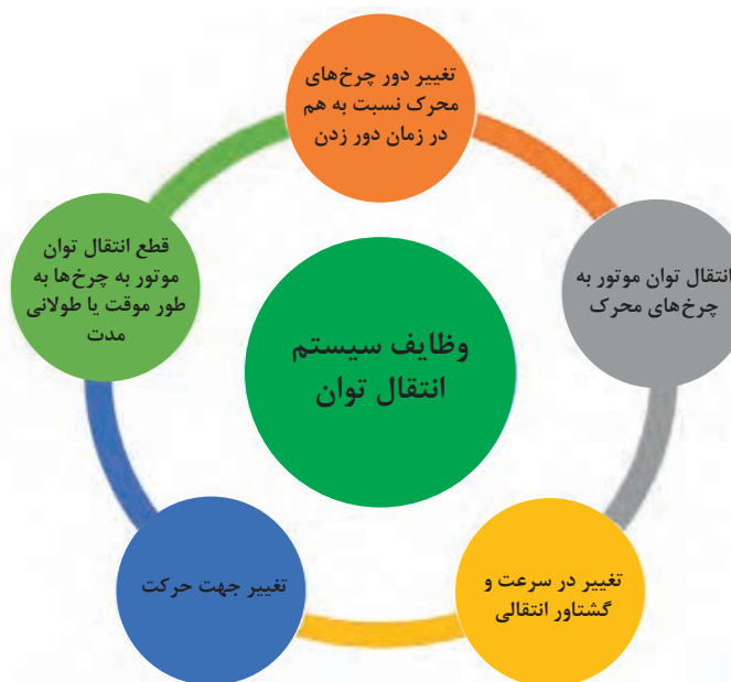
نمودار ۴-۲- وظایف سیستم انتقال توان
