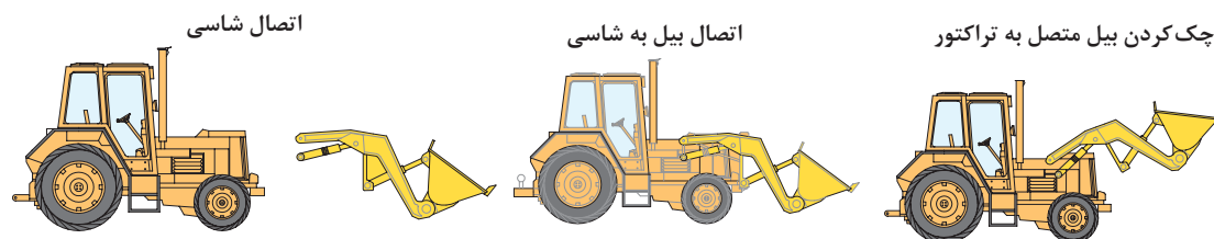
شکل ۷۰-۱- مراحل اتصال بیل به تراکتور
