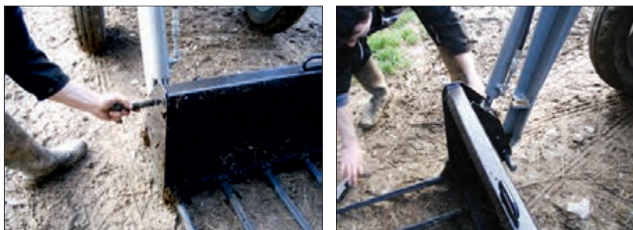
(الف) (ب) شکل ۱-۶۷- اتصال باکت‌ها به بیل
