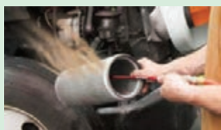
شکل ۱۴-۳- باد گرفتن صافی داخلی
