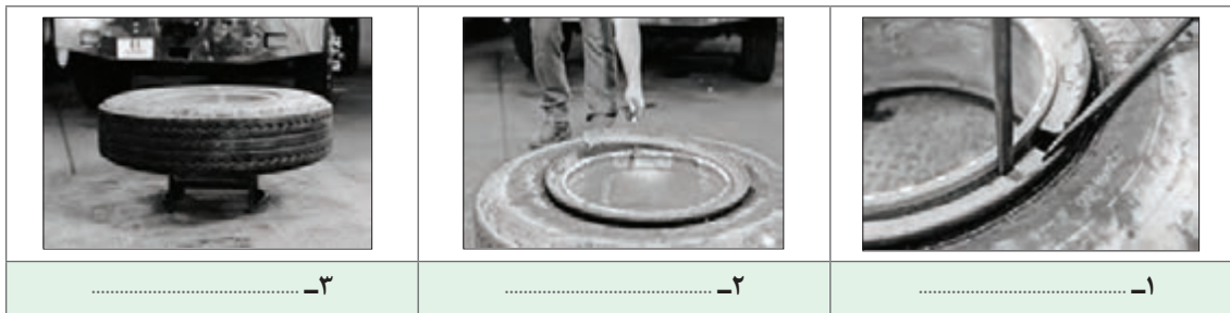
شکل ۷۳-۴- جدا کردن تایر از رینگ دو تکه
