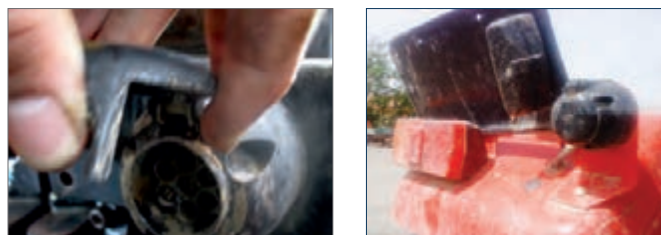
شکل ۲۳-۱- پریز برق تراکتور
