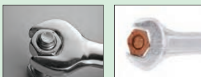
شکل ۷-۲- اندازه مناسب آچار (الف) (ب)
