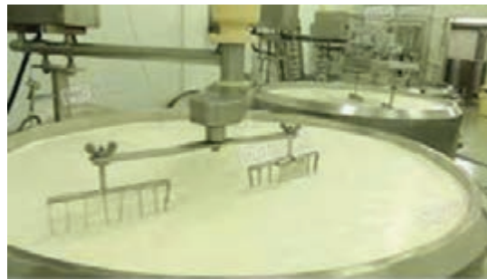
شکل ۴-۴- آب‌گیری و برش لخته
