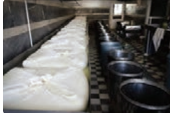
شکل ۴-۳- آب‌گیری از لخته
