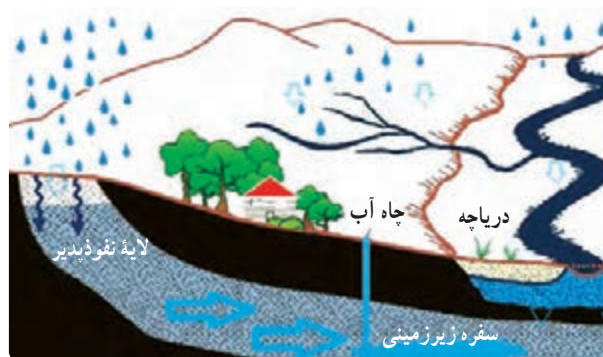
شکل ۴۴-۱- چگونگی شکل‌گیری سفره‌های آب زیرزمینی
