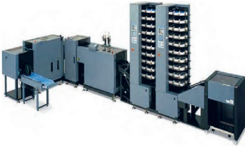
شکل ۶۸ - ماشین ترتیب عمودی با دو ایستگاه
