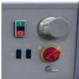
شکل ۳۸- درجه تنظیم فشار دستگاه برش
