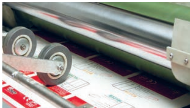
شکل ۲۰- مخزن ورنی و سیستم ورنی‌زنی
