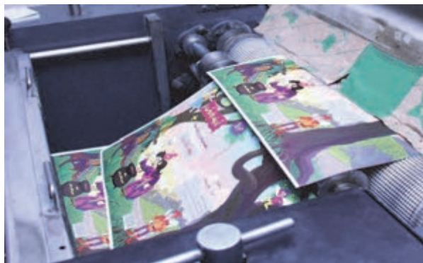
شکل ۱۴- تنظیم قسمت تحویل دستگاه ورنی زنی اسکرین
