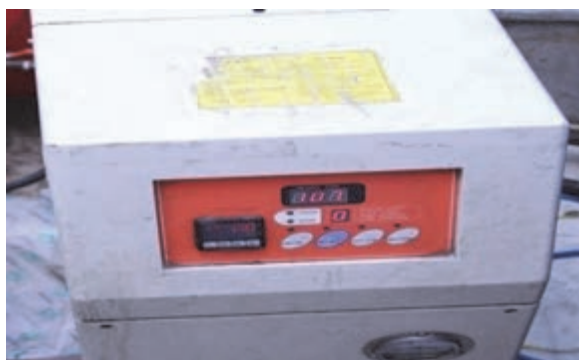
شکل ۳۳- تنظیم درجه حرارت سیلندر
