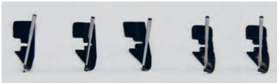
شکل ۳۱- تیغه‌های برش دستگاه دوخت
