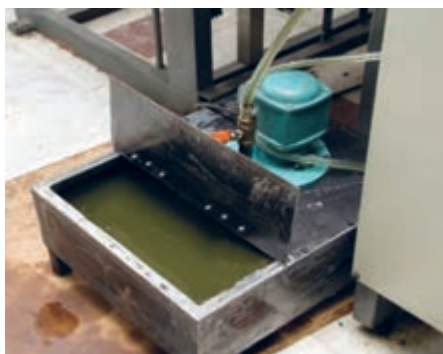
شکل ۲۰- مخزن ورنی و سیستم ورنی‌زنی
