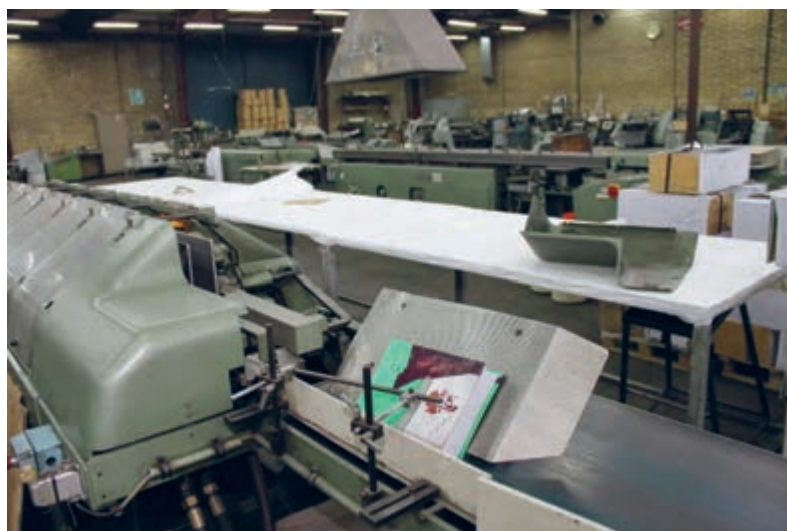
شکل ۶۴- قسمت تحویل دستگاه جلدگذاری
