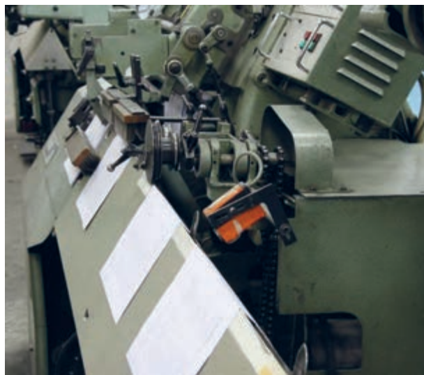
شکل ۲۴- صفحه انتقال دهنده فرم و قطعات آن
