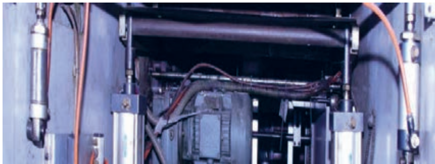
شکل ۳۸- جک های هیدرولیک سیلندر ضربه زننده
