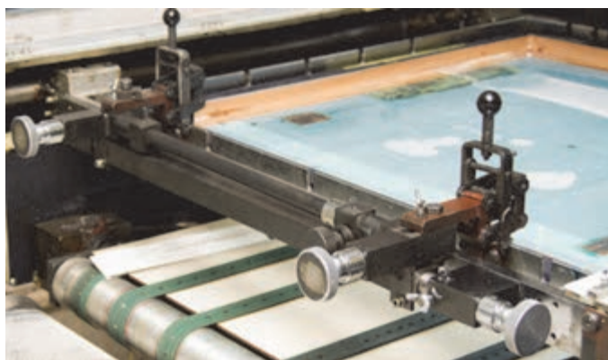
شکل ۱۲- پیچ‌های تنظیم شابلون
