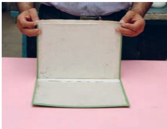
شکل ۴۴- برگرداندن دورتادور پوشش به داخل جلد
