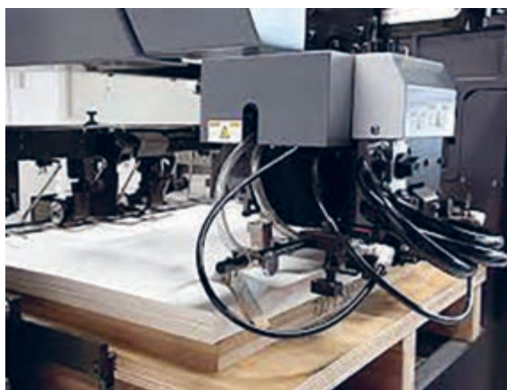
شکل ۲- نحوه قرارگیری در تخته تغذیه ماشین ورق تاکنی
