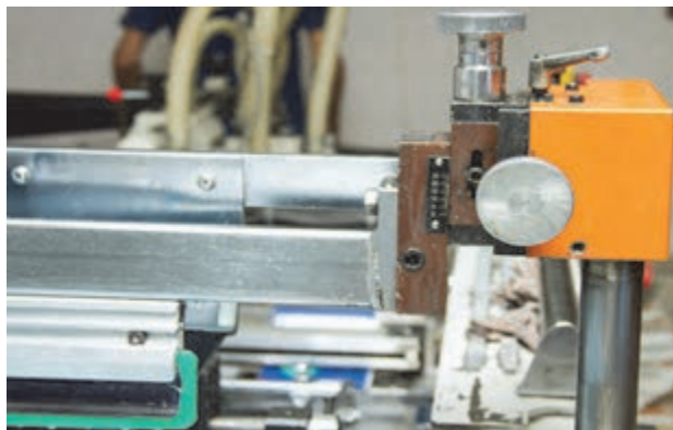
شکل ۱۳- چگونگی تنظیم فشار لبه اسکوییچی
