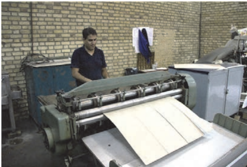
شکل ۴۶- برش لتهای جلد با دستگاه مقوایر
