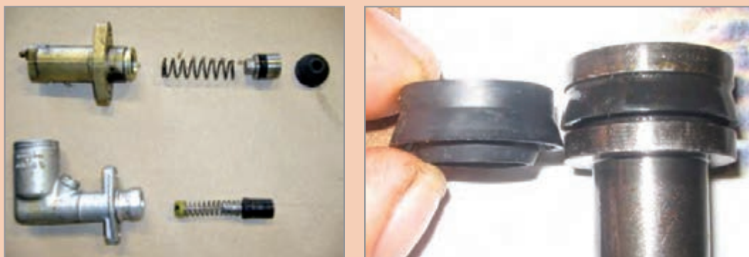
شکل ۲۱-۱- الف - نشتی داخلی در مدار هیدرولیکی
