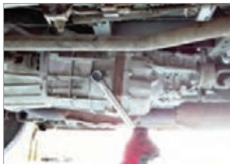
شکل ۲-۲۳- پر کردن روغن جعبه‌دنده
