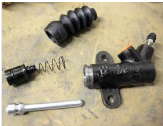
شکل ۱-۲۴- اجزای سیلندر اصلی کلاچ
