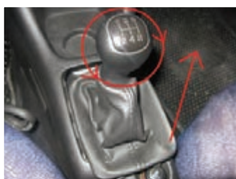
شکل ۲-۲۵- بیرون آوردن سری و گردگیر دسته دنده
