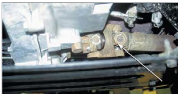
شکل ۶-۳- گاردان با چهارشاخه دویل
