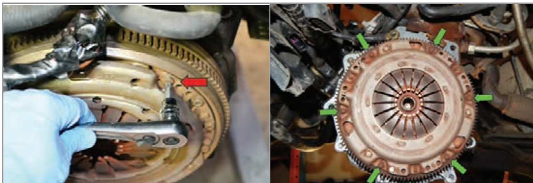
مشخص کردن محل پیچ‌های اتصال
