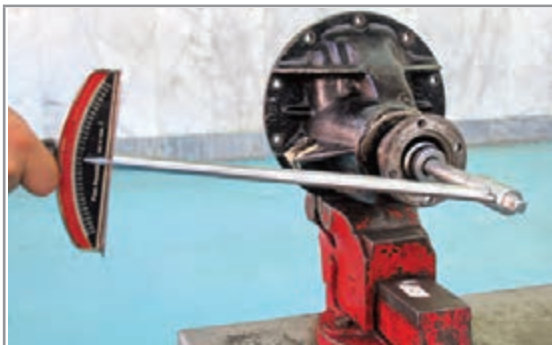
شکل ۴۸-۴- (ب) تعیین گشتاور پیش بار با گشتاورسنج
