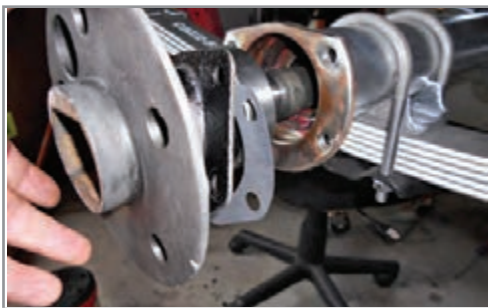
محل نشستن بلبرینگ پلوس روی اکسل را بررسی کنید.
