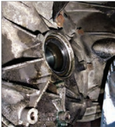
شکل ۲۸-۵- بررسی محل نصب پلوس
