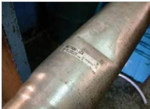
شکل ۱۵-۳- دیدن آثار ضربه روی سطح میل گاردان
