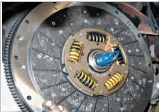
شکل ۱-۳۷- روش قرارگیری شفت هم‌محورکننده صفحه کلاچ
