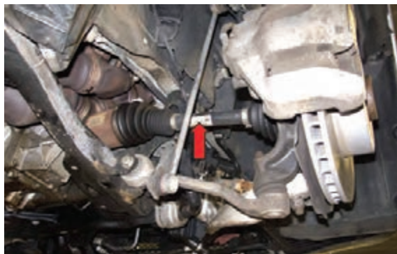
بررسی دسته نگهدارنده جعبه‌دنده
