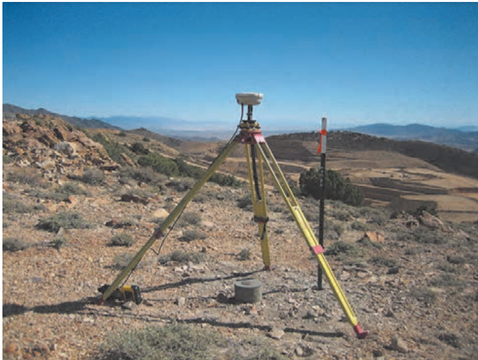
سه پایه دوربین مستقر شده بر روی ایستگاه نقشه برداری
