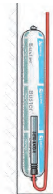
نحوه قرار دادن دینامیت چاشنی گذاری شده درون چال
