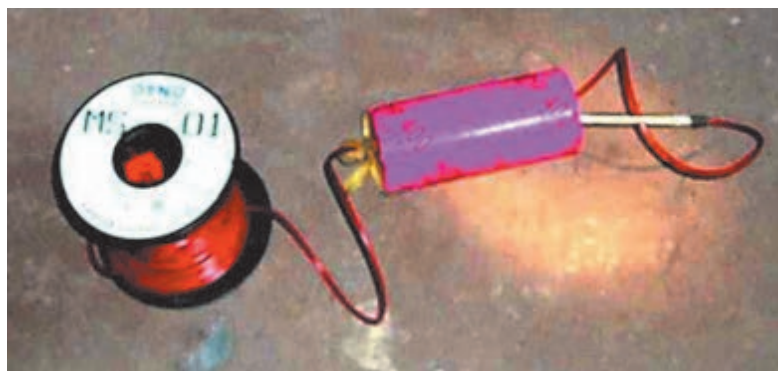
طریقه قرار دادن چاشنی درون دینامیت
