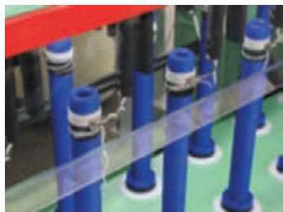
شکل ۳۵- بوبین پلاستیکی نصب شده روی دوک
