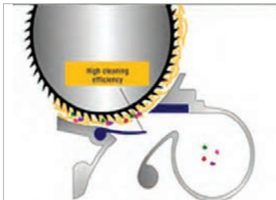
شکل ۱۱- نمایی از سیستم تغذیه زنده‌ای در ماشین چرخانه‌ای
