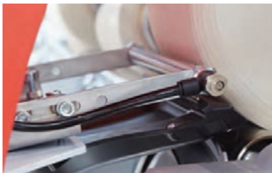
شکل ۵۰- کنترل فشار و اندازه بوبین و داف کردن
