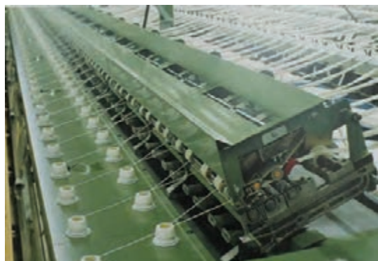
شکل ۳۳- خروج نیمچه نخ از منطقه کشش
