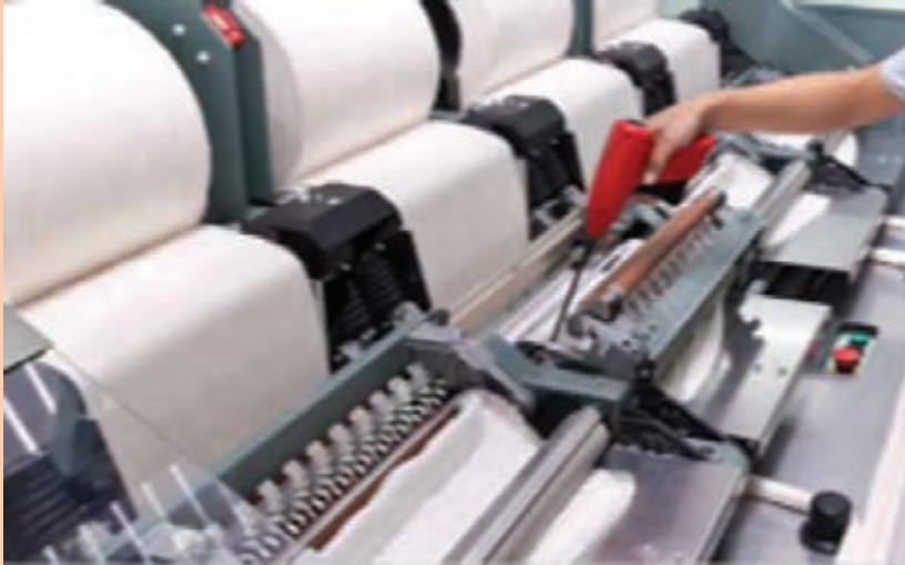
شکل ۴۳- روش پرزگیری با تفنگی پرزگیر
