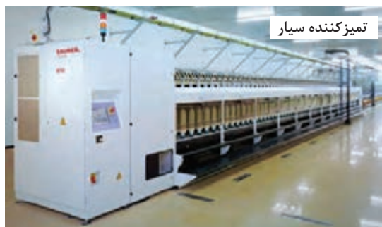
شکل ۵۲- تمیزکننده سیار روی فلایر
