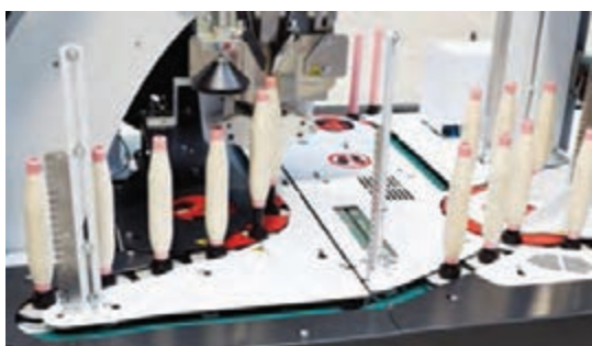
شکل ۳۷- ماسوره‌های رینگ در حال تغذیه به اتوکنر
