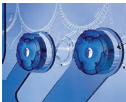
شکل ۵۲- سنسور کنترل ضایعات در تمیزکننده‌ها
