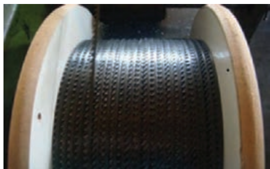
شکل ۲۴- قرقره‌های حاوی نوار متالیک
