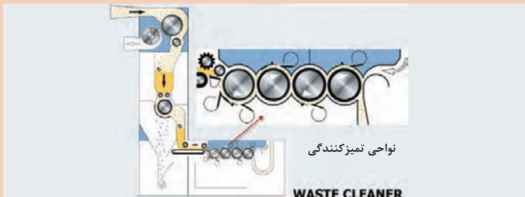
شکل ۵۱- نمای دستگاه تمیزکننده ضایعات
