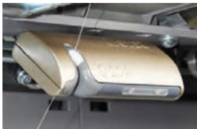
شکل ۱۴- کنترل‌کننده و تمیزکننده نخ
