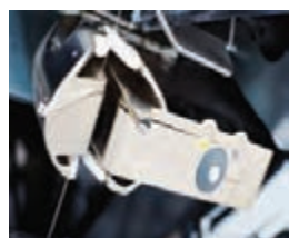
شکل ۴۶- کنترل‌کننده تمیزکننده و قطع‌کننده نخ
