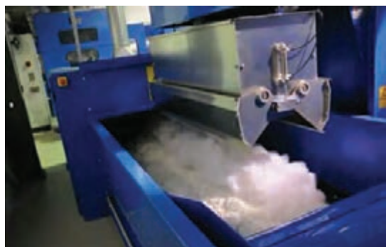
شکل ۵- سیستم تغذیه با یک ترازو (وزنی)
