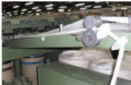
شکل ۴- جفت غلتک راهنمای فتیله و قطع کننده حرکت ماشین در صورت پارگی فتیله
