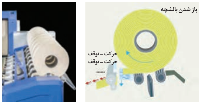
شکل ۳۲- بخش باز شدن لایه بالشچه یا تغذیه
