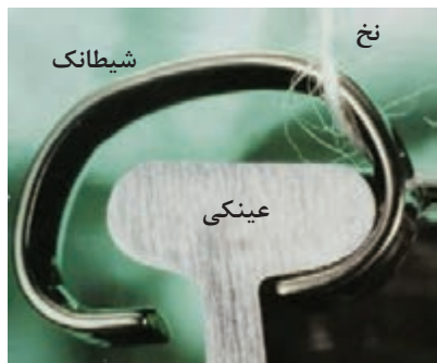
شکل ۲۰- محل عبور نخ از بین شیطانک و عینکی می‌گذرد
