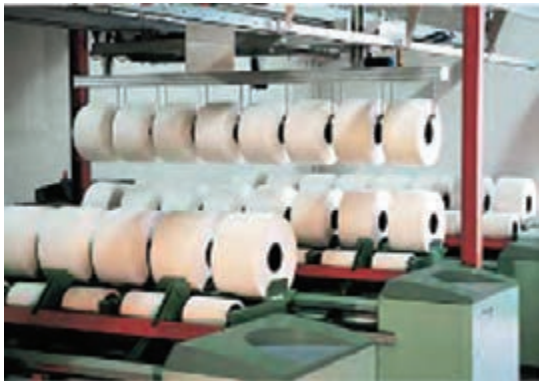
شکل ۲۸- نحوه قرارگیری بالشچه‌ها روی دستگاه شانه
