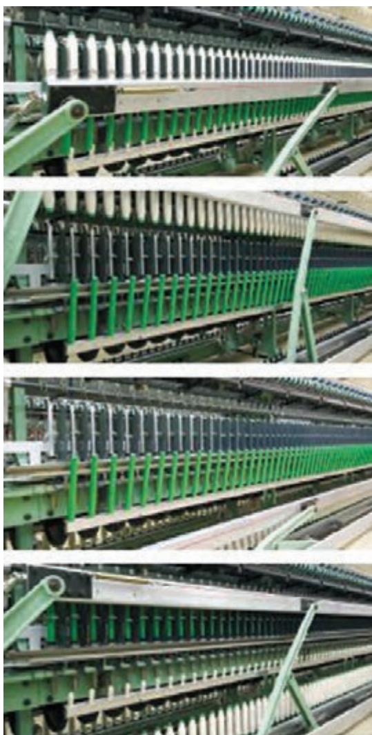
شکل ۳۵- مراحل داف اتوماتیک در ماشین رینگ و مراحل آن
