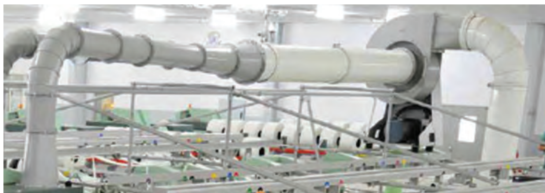
شکل ۲۴- تقویت فشار انتقال الیاف
