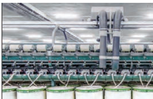
شکل ۱۶- تمیزکننده سیار روی ماشین چرخانه
