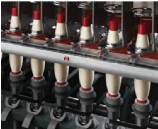
شکل ۳- فاصله دو دوک متوالی در دستگاه رینگ
