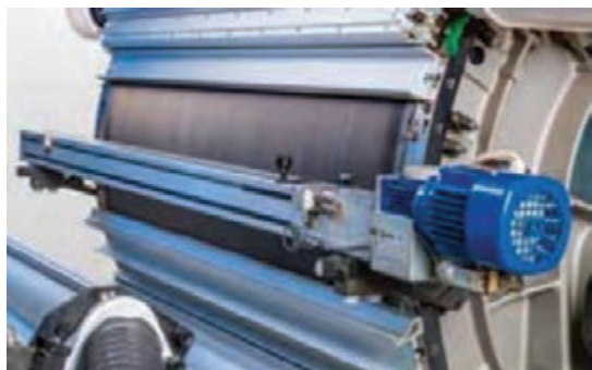
شکل ۲۳- ابزار آلات مخصوص سنگ زدن وایرهای سیلندر و دافر
