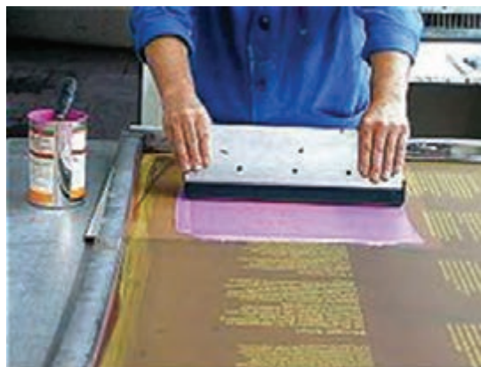
شکل ۶- راکل کشیدن روی توری
