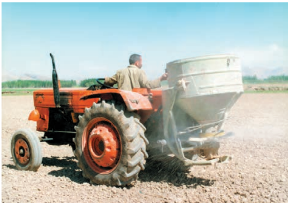
شکل ۸-۴ – پخش کود شیمیایی به وسیله کودپاش ساتریفوز
