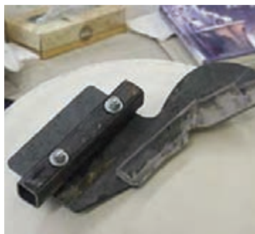
شکل ۱۶- شابلون با پیچ و مهره قابل تنظیم
