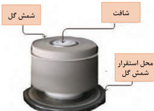
شکل ۱۵- استقرار شافت و شمش گل
