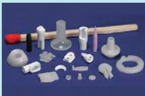
شکل ۱۳- میکروسازه‌های سرامیکی تولید شده به روش قالب‌گیری تزریقی
