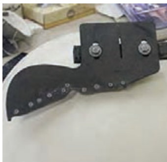
شکل ۱۶- شابلون با پیچ و مهره قابل تنظیم
