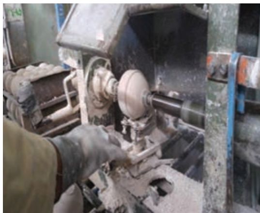
شکل ۵- شکل‌دهی قطعات سرامیکی به روش تراش
