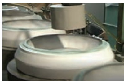
۳۴- قرار دادن دیسک گل در قالب
