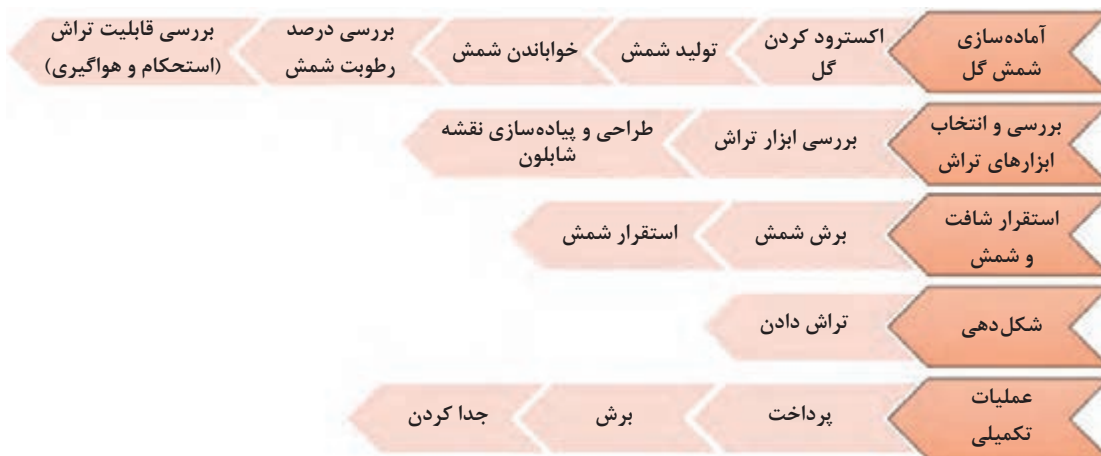
شکل ۷- مراحل شکل‌دهی گل پلاستیک به روش تراش
