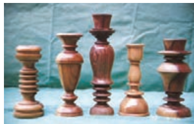
شکل ۲- قطعات چوبی شکل داده شده با تراش
