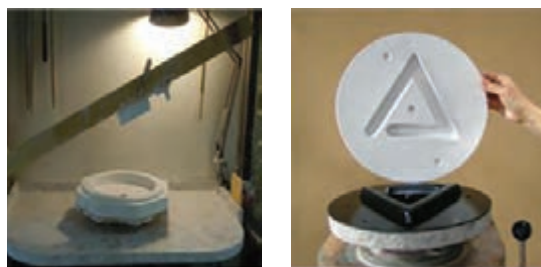
شکل ۱۲- انواع سرچرخ مورد استفاده در دستگاه جیگر
