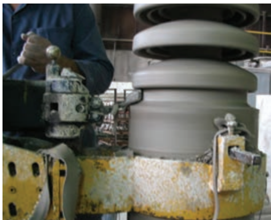
شکل ۵- شکل‌دهی قطعات سرامیکی به روش تراش
