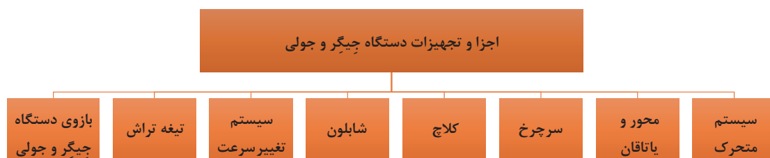
نمودار ۴- اجزا و تجهیزات دستگاه جیگر و جولی
