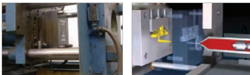
شکل ۲۱- قالب تحت فشار و تزریق
