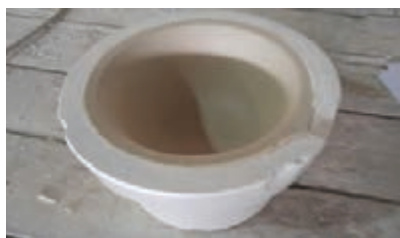
شکل ۳۹- چسبیدن گل به قالب
