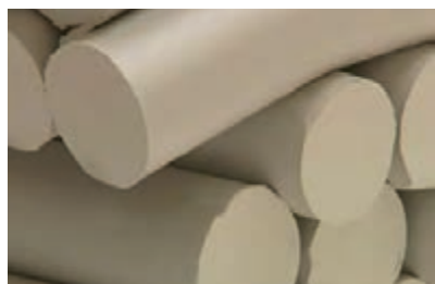
شکل ۵- اکستروود کردن گل پلاستیک
