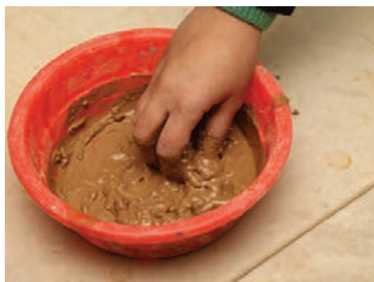
شکل ۱۰- تهیه گل یکنواخت با دوغاب
