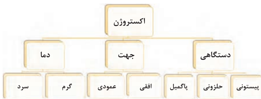
نمودار ۲- روش‌های متداول شکل‌دهی به روش اکستروژن
