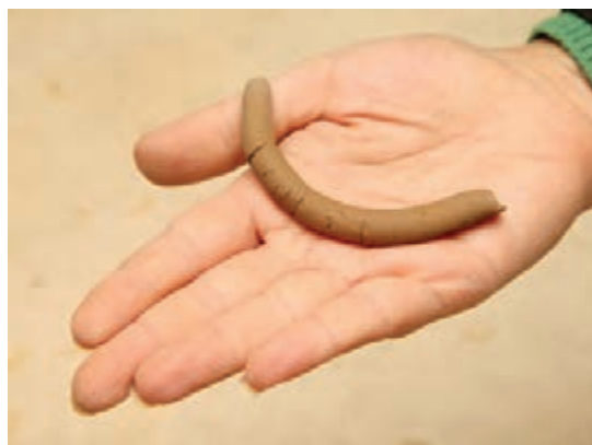
شکل ۱۴- بررسی فتیله در روش آتربرگ
