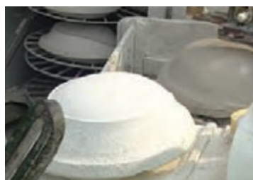
شکل ۲۷- قرار دادن قالب بر روی زبانه
