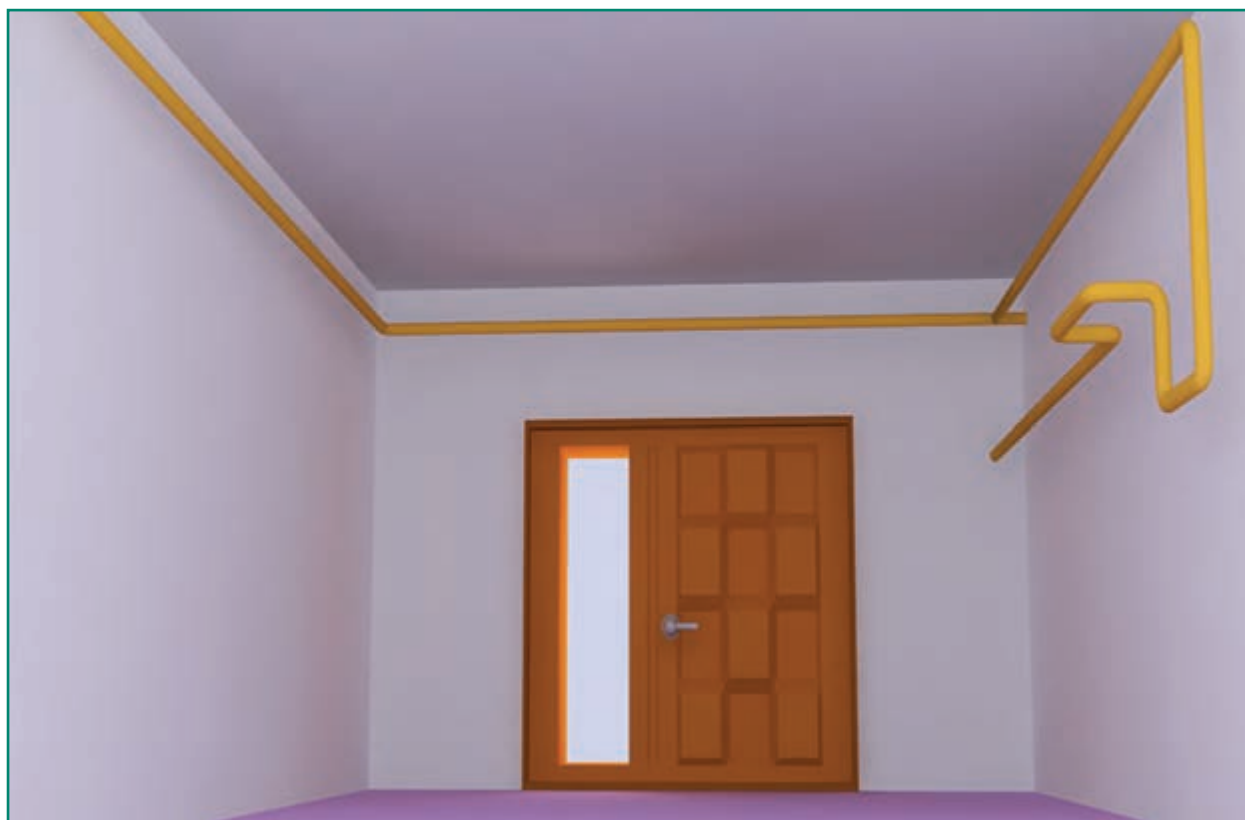
شکل ۴-۲۳ الف نمایش مسیر لوله‌ها در داخل راهرو
