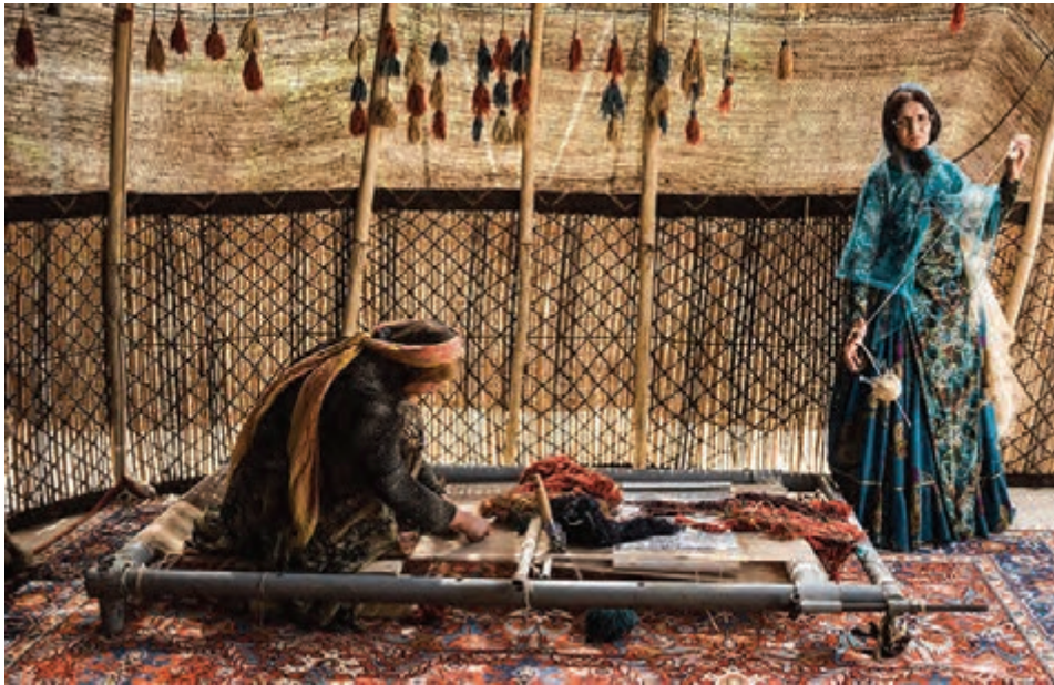
شکل ۷-۱- دار قالی بافی قابل استفاده به دو صورت عمودی و افقی
