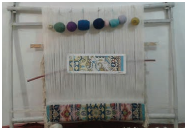
شکل ۲۰-۱- مقاوم نبودن سر دار و زیر دار در این تصویر کاملاً مشهود است.
