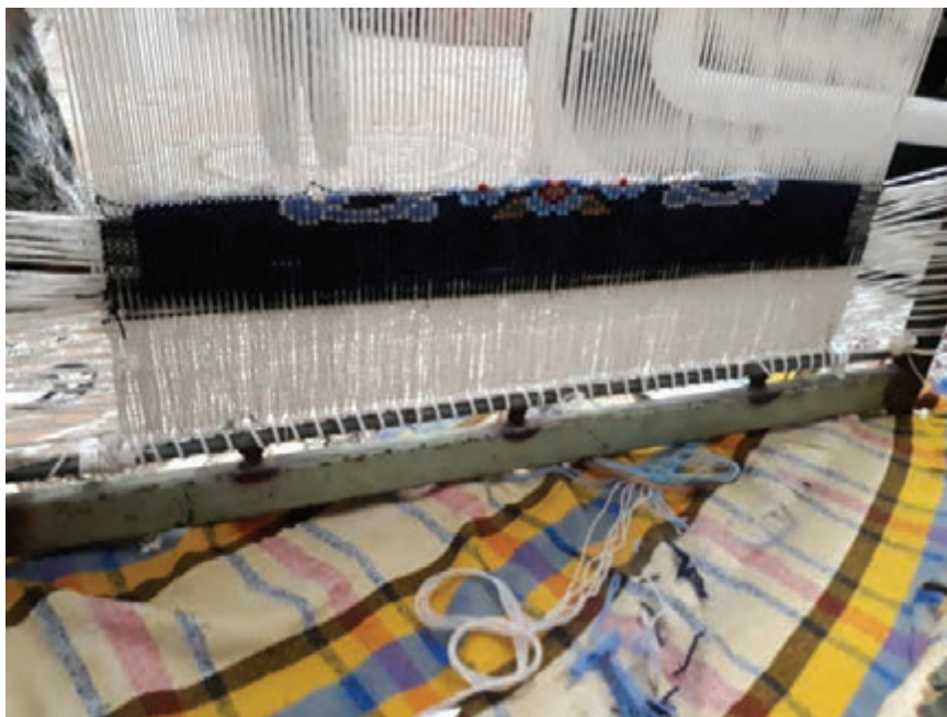
شکل ۱-۲۶- میله جوش شده، روی زیر دار از داخل، جهت دوخت ابتدای چله بعد از چله ریزی با نخ پنبه ای ضخیم
