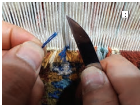
شکل ۱۲-۴- نحوه اجرای گره فارسی
