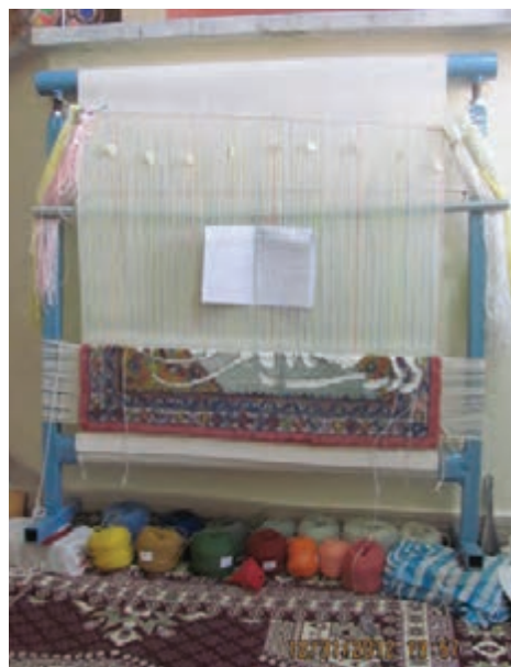
شکل ۱۰-۱- زیردار ثابت و سردار متحرک (مدل ۲)
