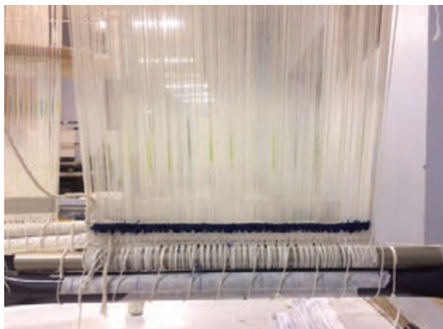
شکل ۱۰-۳- اتصال چله به زیردار به روش دوخت با میله کمکی و نخ پنبه‌ای
